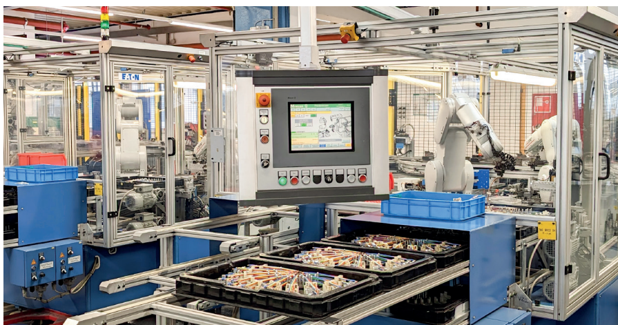
Im Werk Schrems werden mithilfe von Robotern Komponenten für Schutzschalter und Verteilerkästen produziert.
