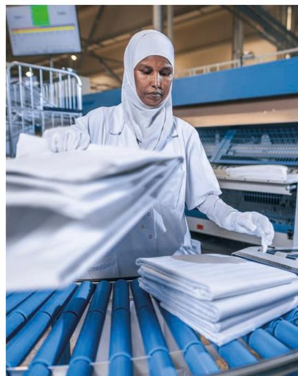
Zu den ergonomischen Maßnahmen im Betrieb zählt die Automatisierung des Wäschetransports.
